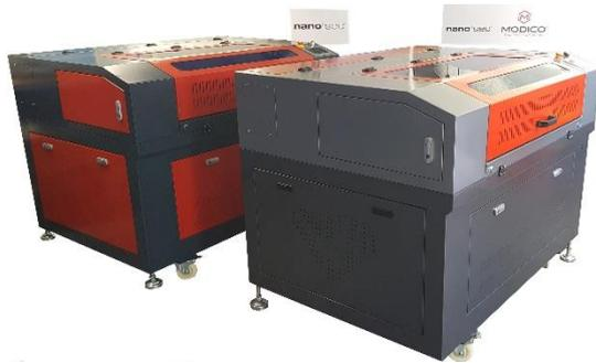
Die kompakten Laserportale mit Laserscanner NSP-9060-xx stehen für NanoSec Laser Bearbeitungssysteme, die auf hochwertigen Faser Laser, oder CO<sub>2</sub> Laser Technologien aufbauen. Die Laserwellenlänge von 1064nm, oder 10600nm, sind für die Beschriftung von allen Metallen, oder Kunststoffen, organischen Materialien, als auch Glas, geeignet.
